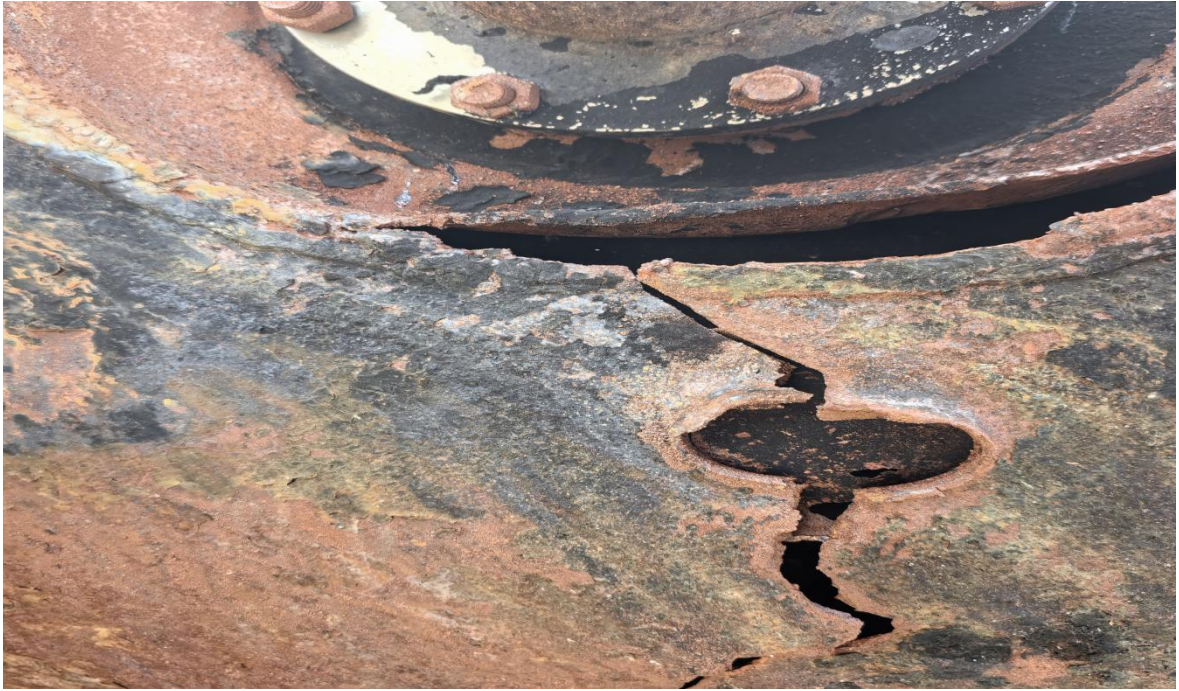
4号反应釜事故后底部变形
