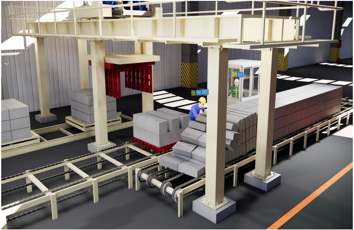
复原图片（左侧输送带砌块坍塌）
