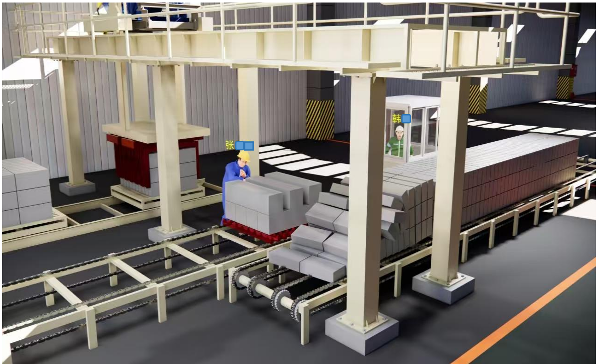
复原图片（未关闭系统进入危险区作业）
